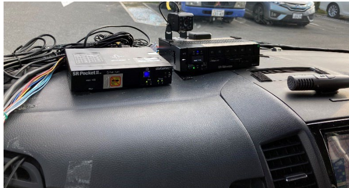
図 3：実証に用いたデジタルタコグラフ SR (左側)
