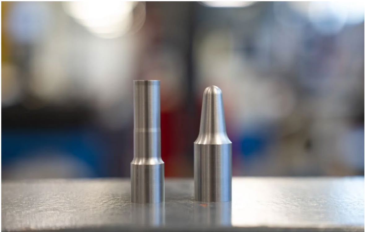
Foundation Alloy 製 モリブデン基合金鍛造金型
